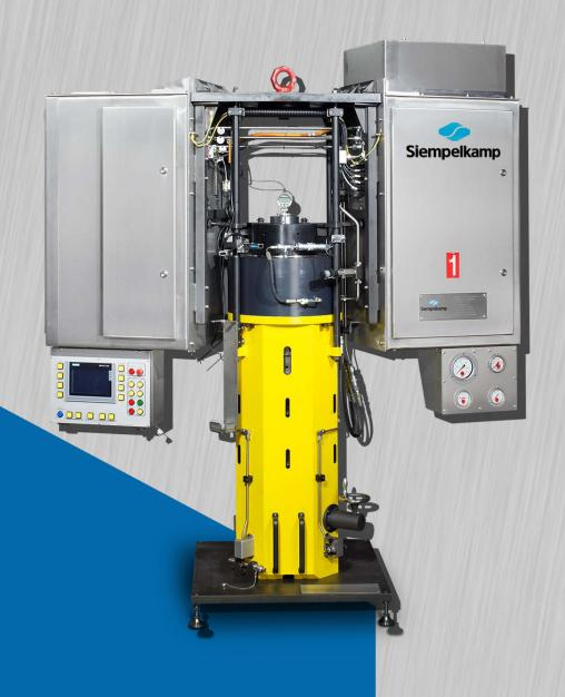
Single Stud Tensioner incl. Test & Storage Stand PWR-AP 1000 MW
