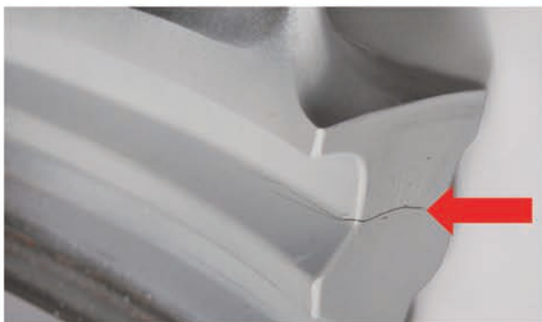
Anriss einer ND-Endschaufel nach kürzester Betriebszeit aufgrund Anregung durch ungünstige Dampfströmung
