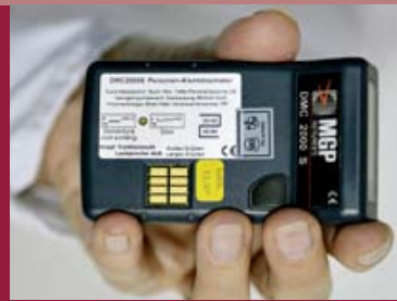
Personalarmsdosimeter: Bei Überschreitung von vordefinierten Werten wird ein Alarm ausgelöst
