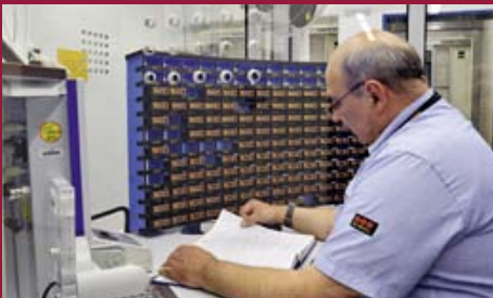
Ausgabestelle der Dosimeter vor dem Eingang zum Kontrollbereich im KKW
