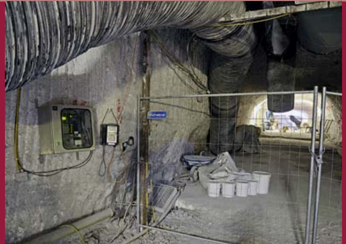
Dosimeterleser (links) auf der 750-m-Sohle in der Schachanlage Asse am Eingang des Überwachungsbereiches (Foto: Asse-GmbH)
