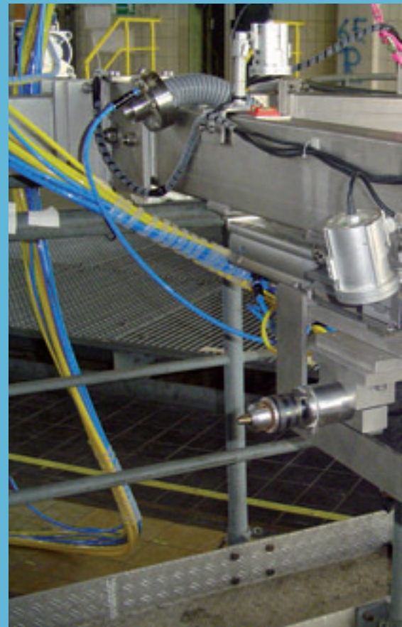
(Abb. 3) Geräteträger mit pneumatischen Bohrmaschinen, DL-Messsonden und UW-Videotechnik
