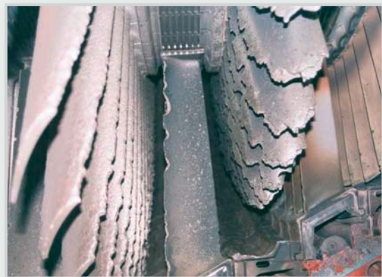
Schaufelschaden Quelle: VDI Bericht Juni 2003
